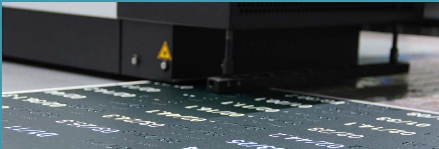
Indem wir mehrere Schichten Druckfarbe auftragen, sind die Zeichen ausreichend erhaben, um sie tasten zu können. Die in diesem speziellen Herstellungsverfahren erzeugten Schriften und Zeichen sind zudem sehr beständig, da die Druckfarbe der oberen Schicht die darunter liegenden Schichten abdeckt und sich somit keine der Schichten einzeln ablösen kann. Und: Die Haptik der Zeichen wirkt durch ihre abgerundeten Kanten besonders angenehm.
